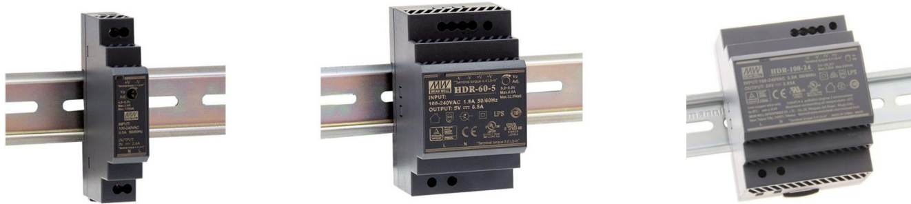
Alimentations pour montage sur rail DIN 24V AC ou 24 V DC Puissance de 8 à 160 Watt. Courant de sortie de 0,3 à 6,5A
