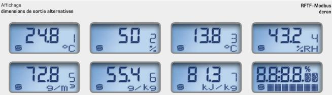
La température réelle et l'humidité réelle (humidité relative) s'affichent en alternance par défaut. Un écran rétro-éclairé est disponible pour une meilleure lisibilité.
