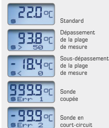
Affichage et propre diagnostic THERMASGARD® Convertisseur de mesure avec écran
