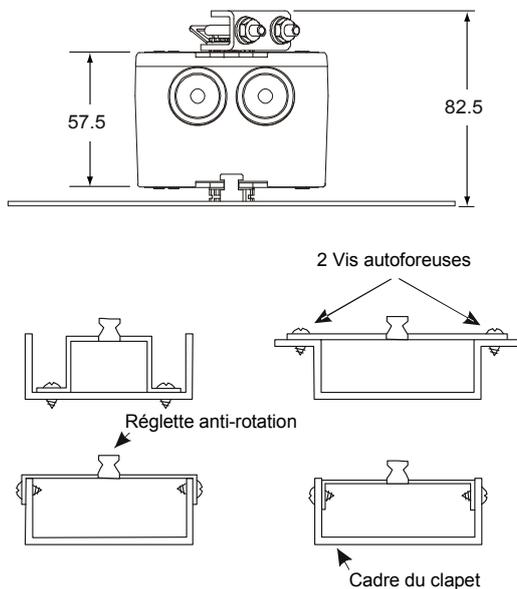
**Figure 5 : Positions de montage de la réglette anti-rotation**
