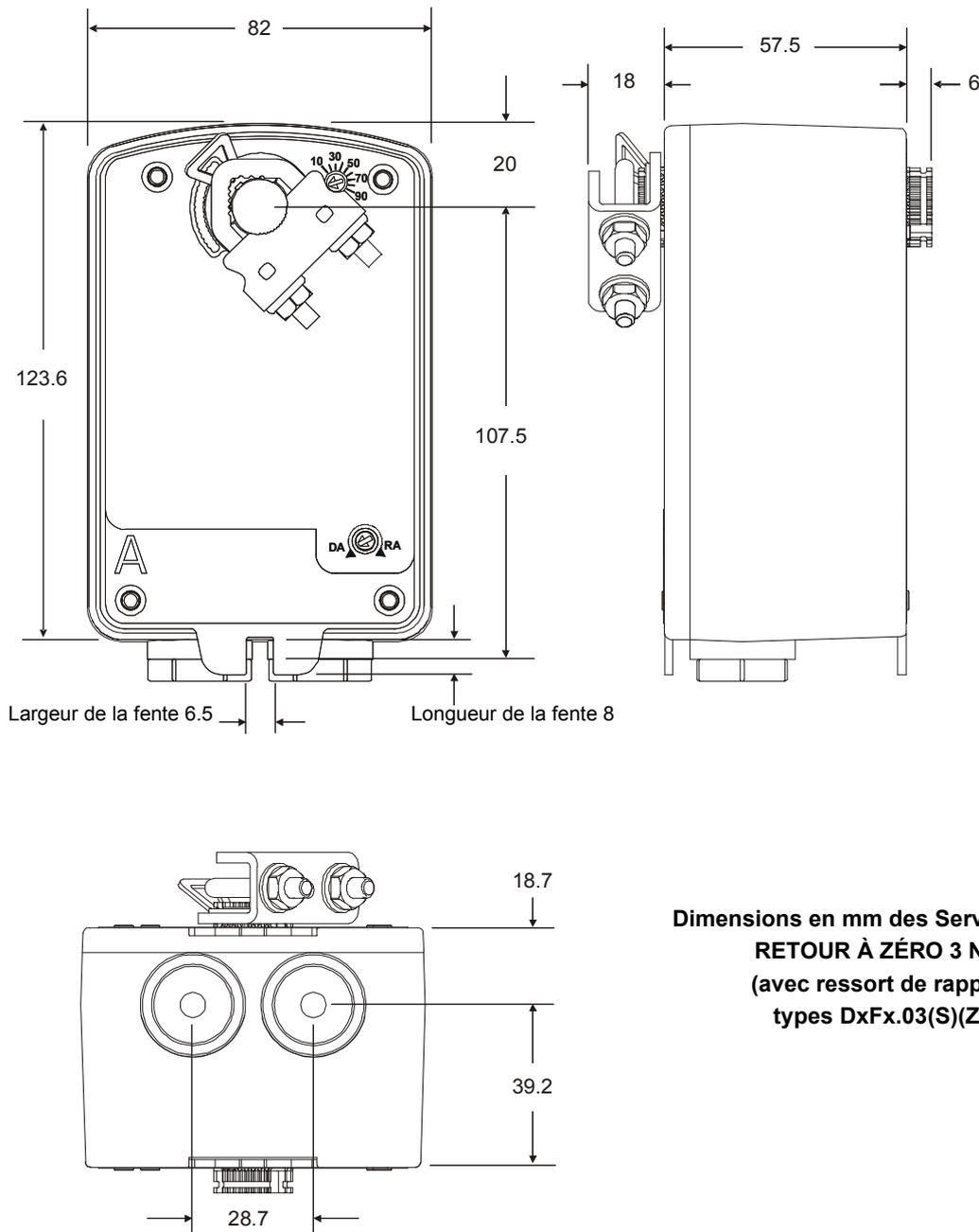
**Dimensions en mm des Servomoteurs
